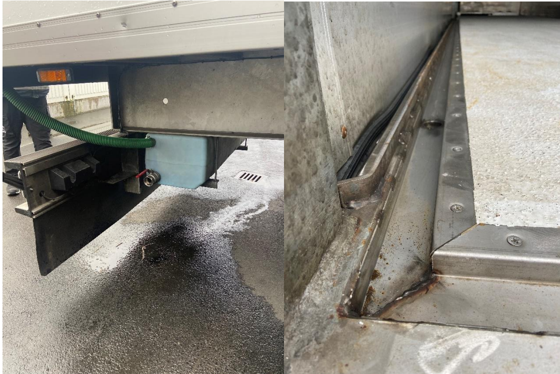
Bilde 2 Venstre: Oppsamlingskåle for smeltevann på islandsk lastebil. Kålen er cirka 100 liter stor og er festet i rammen bak på tralla. Høyre: Renne og avløpshull for oppsamling av smeltevann ved transport av fersk fisk på Island sett fra bakenden av tralla. (Foto: Bjørn Tore Rotabakk, Nofima)
